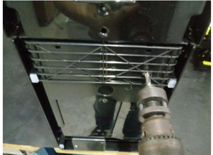
4 – Após furar o centro, retirar a bandeja de agua e furar a carcaça da máquina, utilizar serra copo de 60 mm (milímetros).
