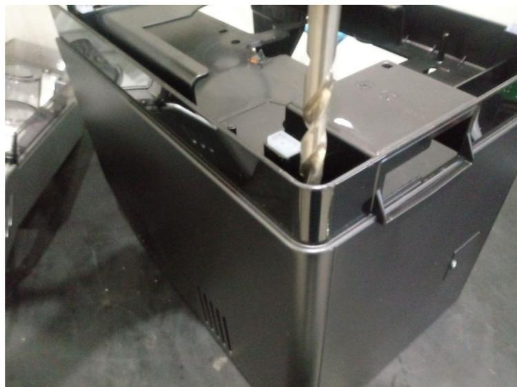
8 – No bloco deve-se cortar um pequeno pedaço no canto para passagem da mangueira para parte de trás da máquina.
