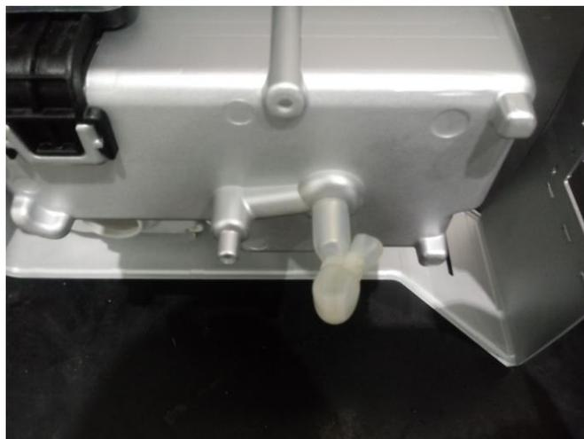
7 – É necessário fazer um furo na carcaça por onde passará a mangueira que vai para o galão, utilizar uma broca de 10 mm (milímetros) e fazer bem no canto da carcaça conforme imagem abaixo.
