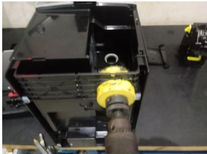
5 – Após furar a cacaça, furar a bandeja. O furo da bandeja não deve cortar abas ao redor da gaveta de borras, pois se cortar irá vazar agua da bandeja.
